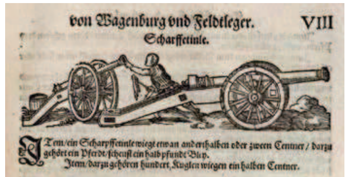
Fig. 10 Leonhardt Fronsperger, Kriegsbuch, Ander Theyl , Frankfurt am Mayn 1573, tav. VIII, a sinistra il tipo di cannone da campagna leggero chiamato Scharfentle
